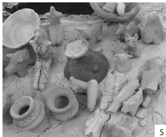
Рис. 9. Результати експериментальних робіт: 1–5 — зразки виробів, випалених в експериментальному горні
